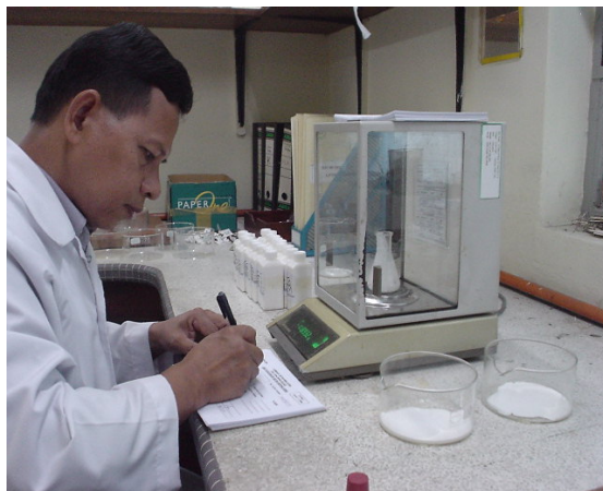
Gambarajah 3: Menimbang contoh lateks untuk ujian kandungan getah kering (KGK)
